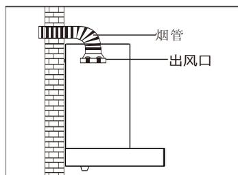
**安装风管:** 将烟管插入出风口座槽内，用ST4.2X12大扁自攻螺钉紧固，最后将风管拉直至室外或公共烟道中。
