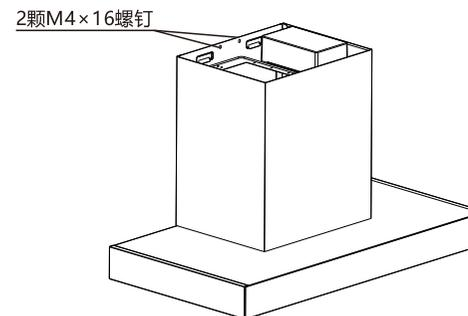
将吸油烟机挂在墙面上，请确保吸油烟机无晃动和脱挂现象，使吸油烟机处于水平状态，然后按上图所示用2颗M4×16螺钉将吸油烟机与挂耳连接固定，防止吸油烟机意外脱落。
