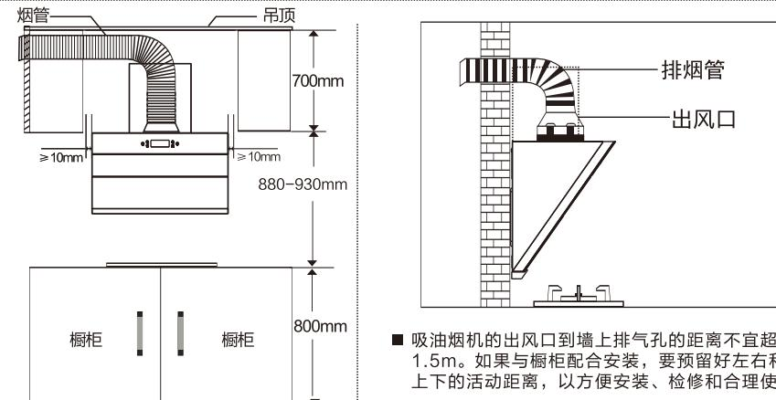
**确定位置：**按尺寸在墙面找出挂耳的安装位置
