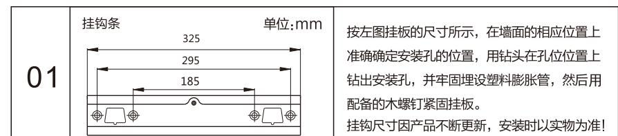
按左图挂板的尺寸所示，在墙面的相应位置上准确确定安装孔的位置，用钻头在孔位位置上钻出安装孔，并牢固埋设塑料膨胀管，然后用配备的木螺钉紧固挂板。
