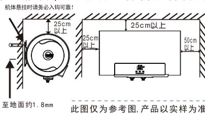
热水器安装时，其安装面安装架（钩）热水器之间的连接应牢固、稳定、可靠，确保安装后的热水器不滑脱、翻倒、跌落。
